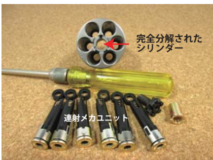
10> シリンダーの穴6個を前から丁寧に棒で押して行けば上記のように一本ずつ連射メカユニット外れます。
