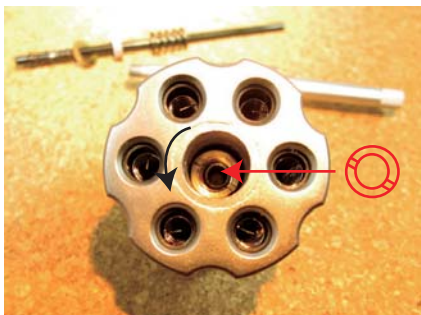
5> シリンダー中央の中に赤線で記載されている形のネジがあります。この径に合う工具を利用してネジを反時計回りに回して外します。
