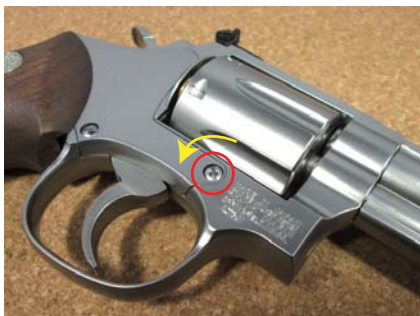
1> 左方向にマイナスネジを外します。
