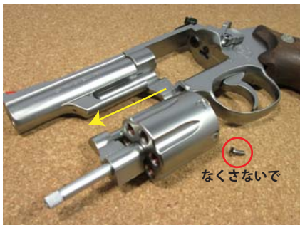
2> ヨークとシリンダーを前方に抜きます。1で外したネジはなくさないでください。
