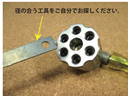
6> 径の合う工具をお探し下さい。今回利用した工具 CAW SAA 用ハンマースプリング
