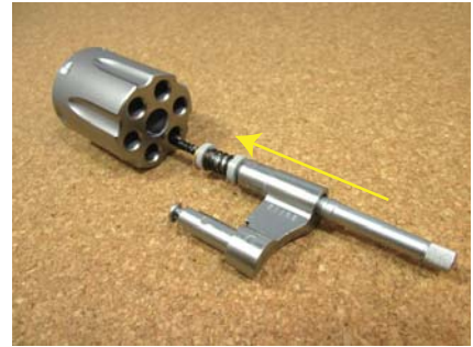
3> 分解図 4 で取り外したヨークを組立て、シリンダー中央穴に戻します。
