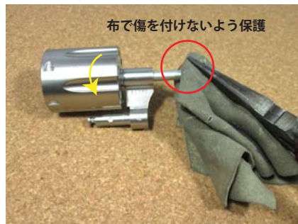
3> ペンチで赤丸部分を布でしっかり固定してシリンダーを手前に反時計回りにまわします。
